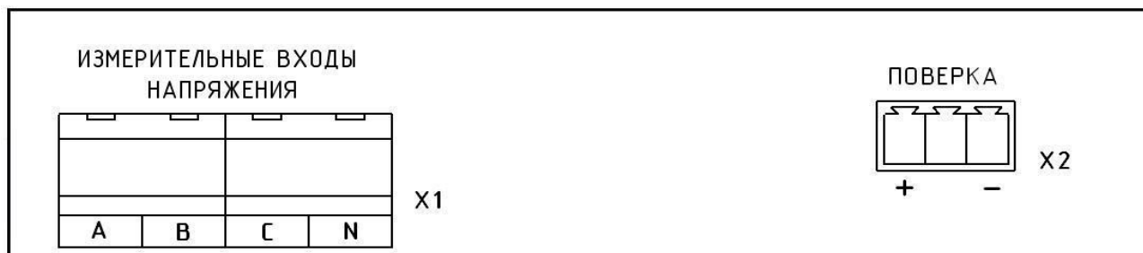
Рисунок Б.6 – Расположение элементов измерительного клеммного отсека приборов «Ресурс-ПКЭ-1.Х-ои-Х»
