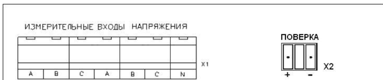
Рисунок Б.7 – Расположение элементов измерительного клеммного отсека приборов «Ресурс-ПКЭ-2.Х-ои-Х»
