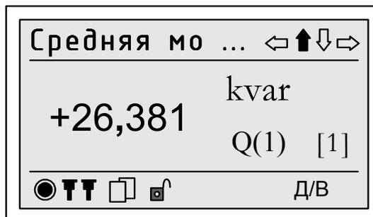
Рисунок 21 – Пример вывода результатов измерений средней реактивной мощности в квадранте 1
