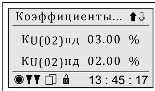
Рисунок 63 – Отображение нормально и предельно допустимых значений коэффициентов гармонических составляющих напряжения
