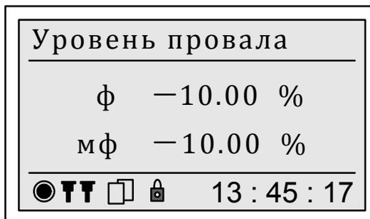
Рисунок 67 – Отображение порогового значения провала напряжения
