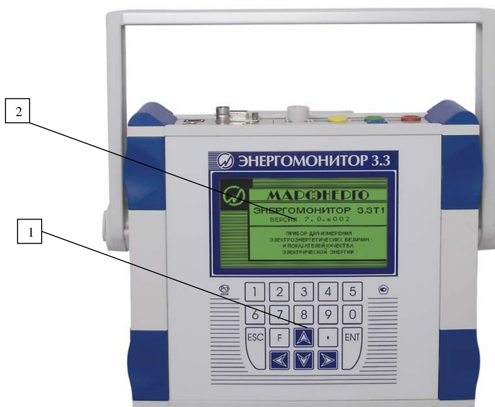
Рисунок 2.1 Лицевая панель прибора «Энергомонитор-3.3Т1» 1 – клавиатура; 2 – дисплей.
