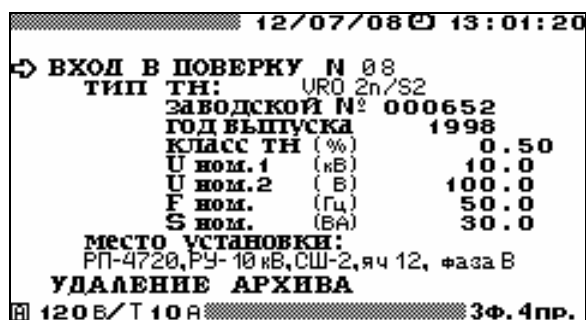
Рисунок 4.6.2 Окно параметров поверки трансформаторов напряжения
