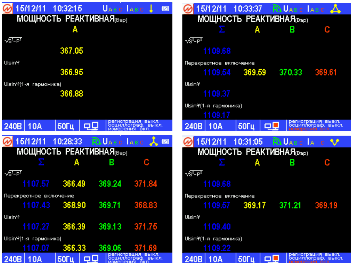
Рисунок 4.8. Экраны режима отображения реактивной мощности для различных схем подключения
