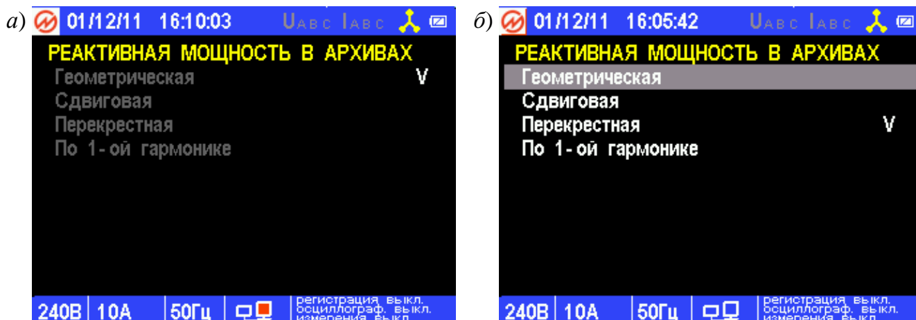
Рисунок 4.55. Меню выбора метода расчета реактивной мощности при работе под паролями 1-го (а) и 2-го (б) уровней
