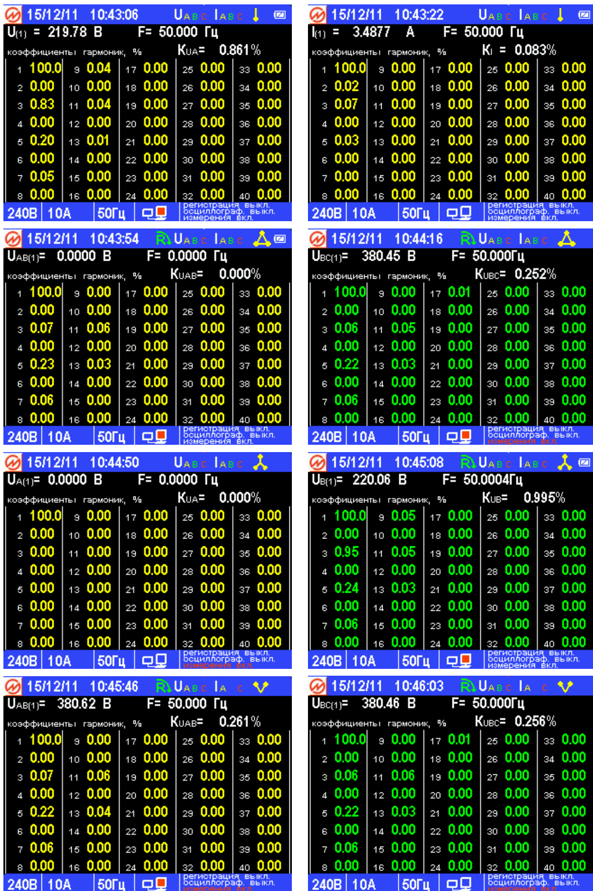
Рисунок 4.11. Экраны режима отображения гармонических составляющих напряжения и тока для различных схем подключения
