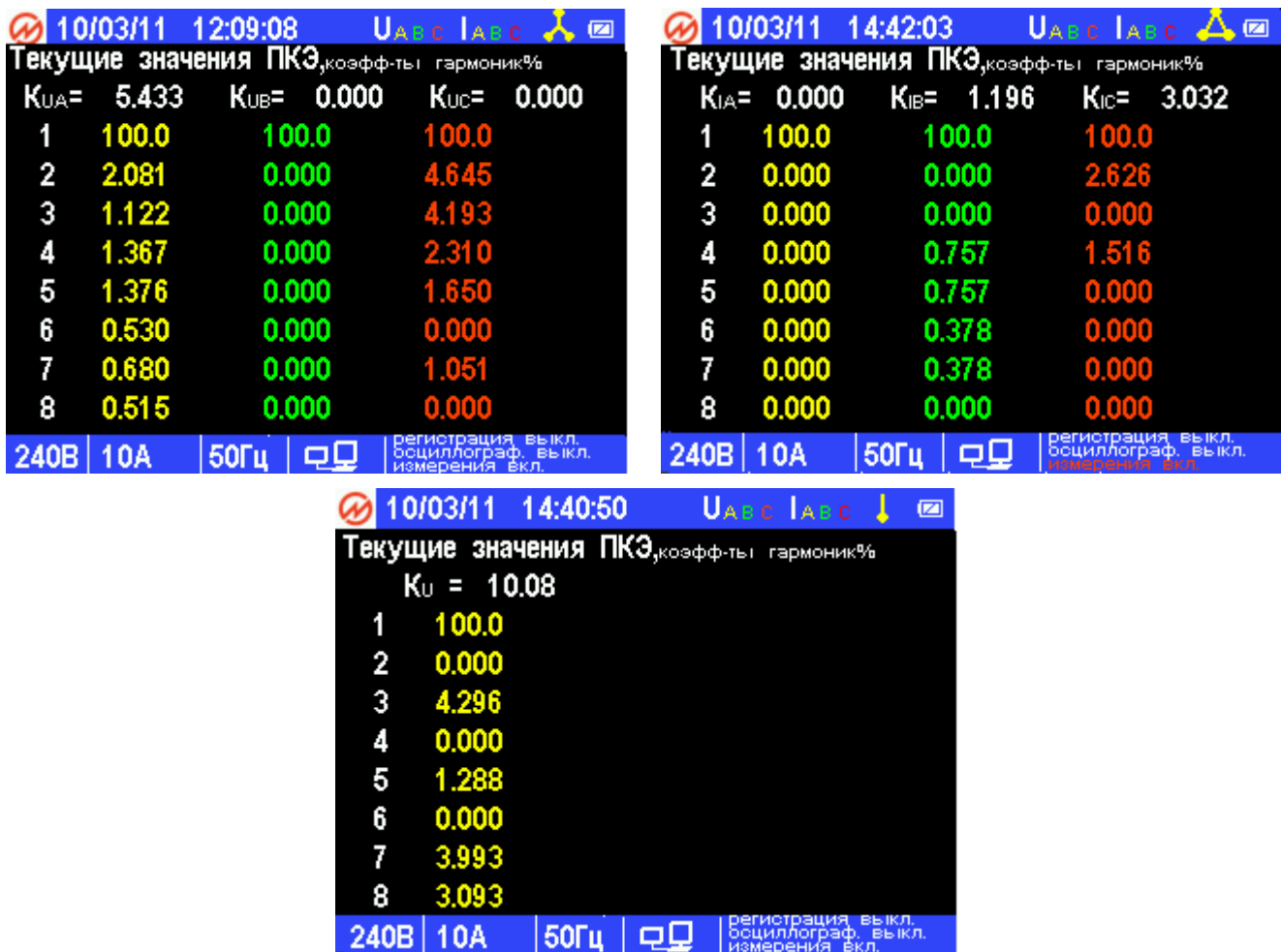
Рисунок 4.30. Окна отображения текущих значений коэффициентов искажения синусоидальности и гармонических составляющих напряжений и токов для различных схем подключения
