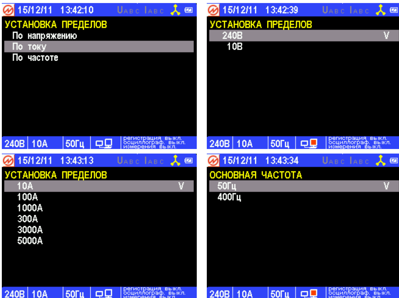
Рисунок 4.42. Меню выбора пределов измерения Энерготестера ПКЭ-А
