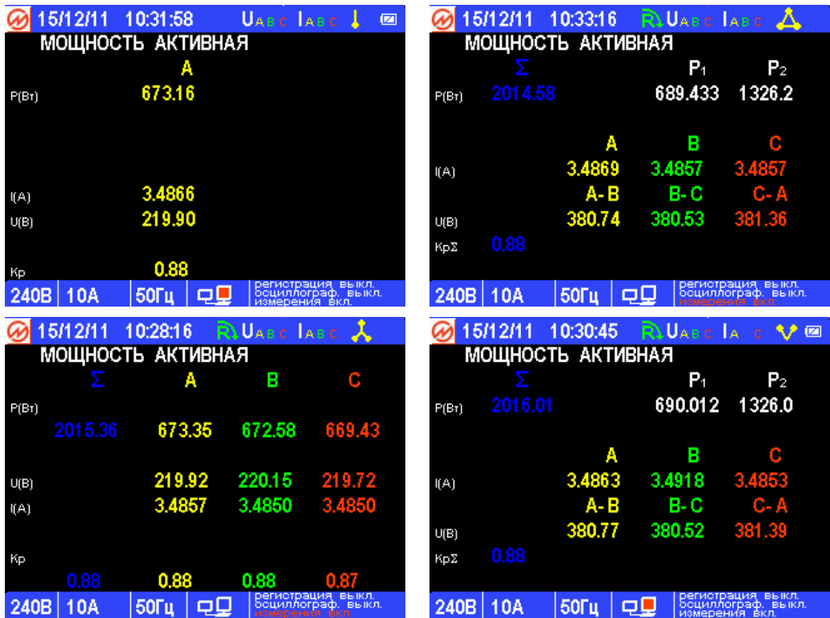
Рисунок 4.7. Экраны режима отображения активной мощности для различных схем подключения
