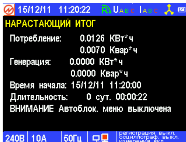
Рисунок 4.15. Экран режима измерения энергии нарастающим итогом
