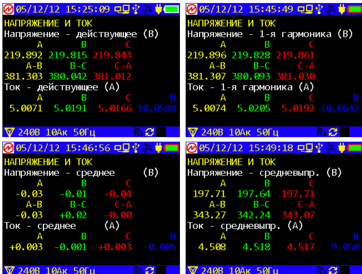
Рисунок 4.2.2 - Отображение напряжений и токов для трехфазной четырехпроводной схемы включения
