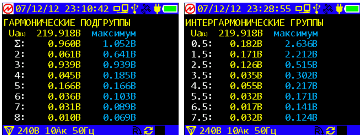
Рисунок 4.2.8 - Примеры экранов «Значения» из подменю «Гармонические подгруппы» и «Интергармонические группы»
