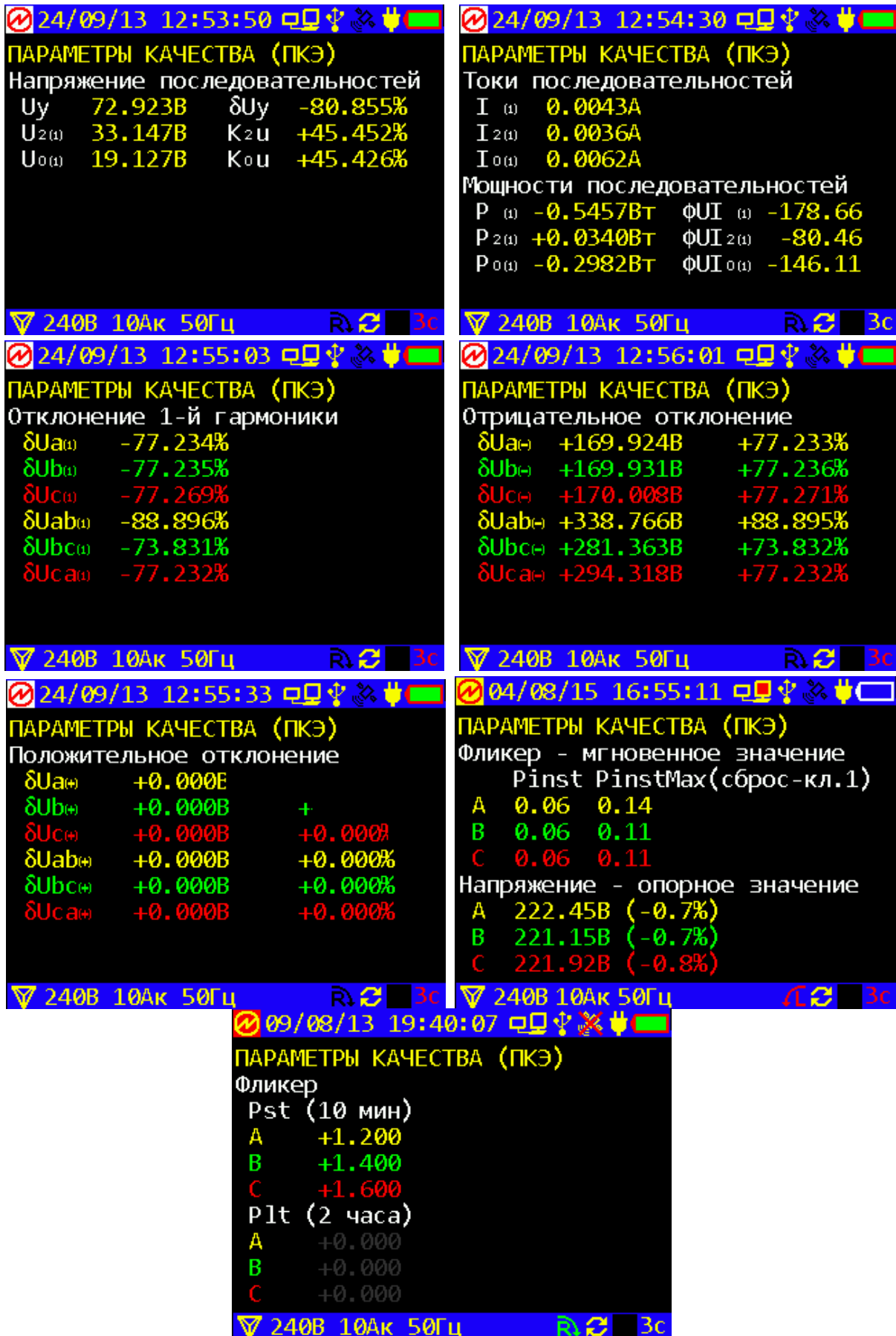
Рисунок 4.2.4 - Экраны режима отображения текущих ПКЭ
