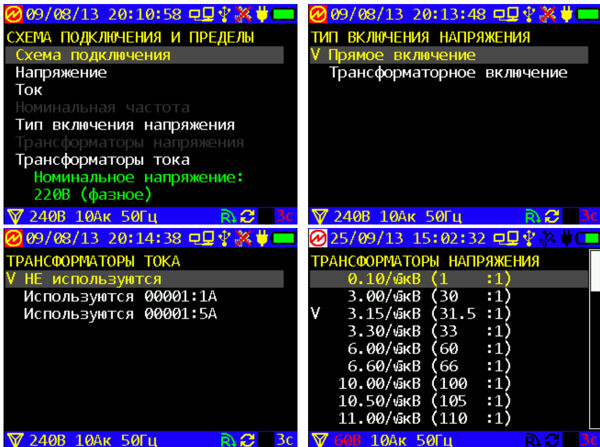
Рисунок 4.4.4 - Экраны для выбора трансформаторов
