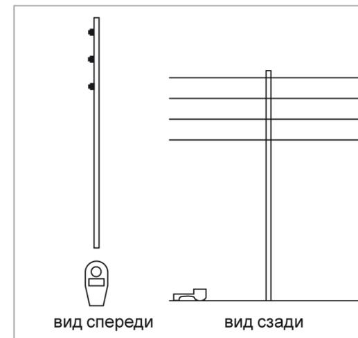
При измерении более одного провода линии необходимо убедиться в том, чтобы все измеряемые провода находились в зоне действия акустического луча прибора.
