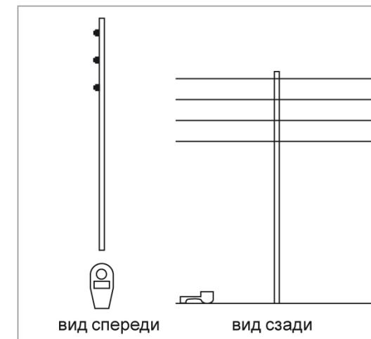
При измерении более одного провода линии необходимо убедиться в том, чтобы все измеряемые провода находились в зоне действия акустического луча прибора.
