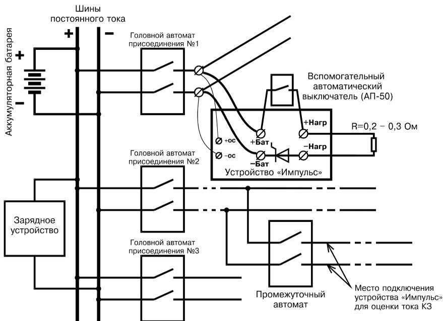
Рис. 4. Применение устройства «Импульс» при измерениях без разрыва цепи присоединения.
