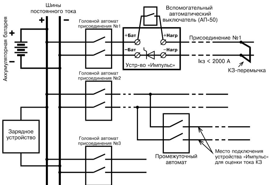
Рис. 3. Схема применения устройства «Импульс» при возможности разрыва присоединения для измерения тока КЗ
