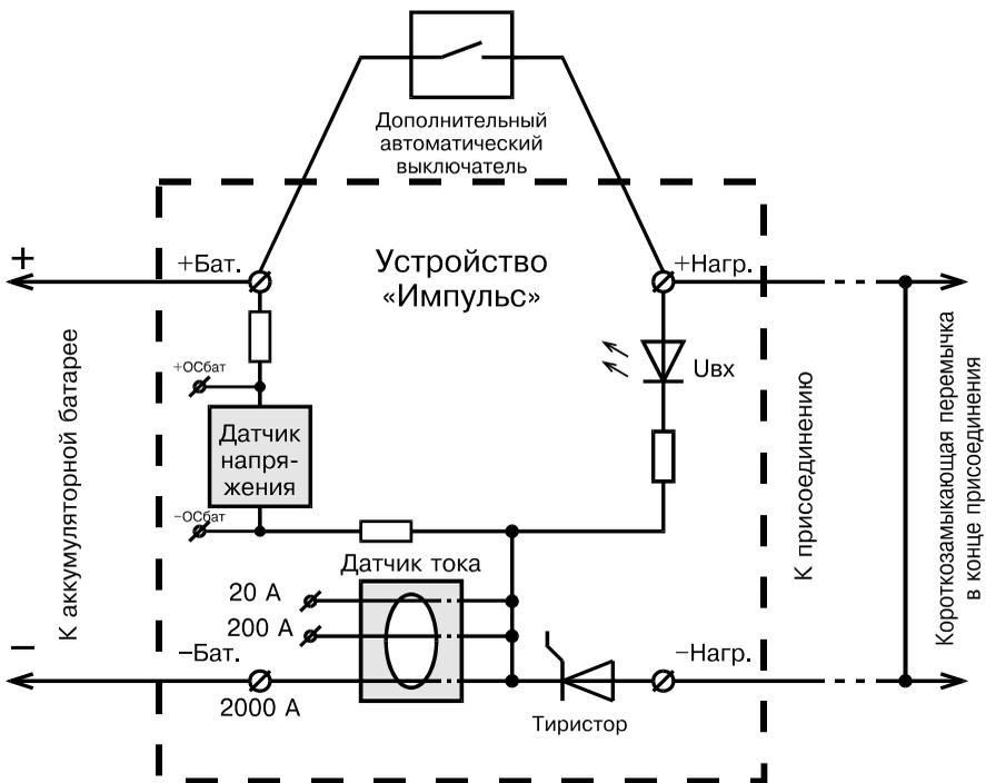
Рис. 5. Схема силовой части устройства «Импульс»
