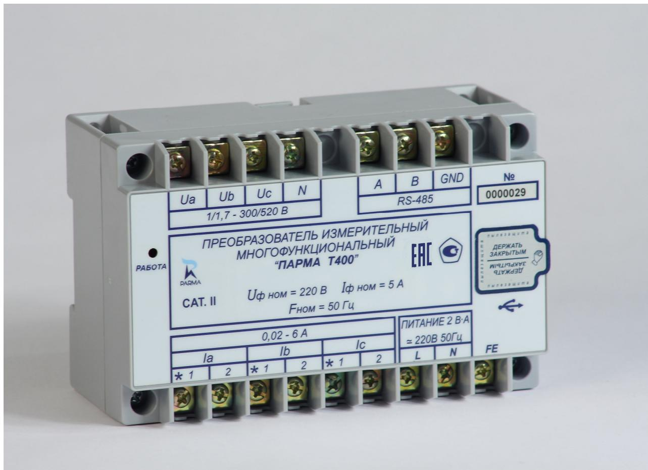
Преобразователь измерительный многофункциональный «ПАРМА Т400»
